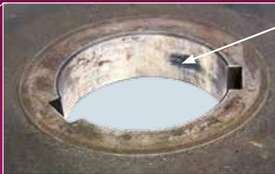
Aufnahmebohrung beschädigt mit Metall-Anbackungen
