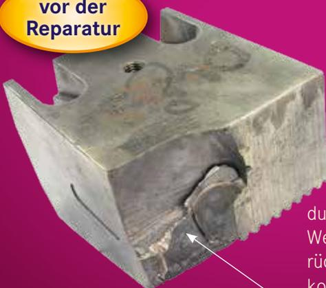
durch Kollision ist der Wendeplattensitz mit rückwärtiger Verzahnung komplett weggebrochen
