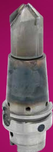
Aus Schrumpfaufnahmen können die eingeschrumpften Werkzeuge, die sich nicht mehr vom Kunden lösen lassen, entfernt werden.
