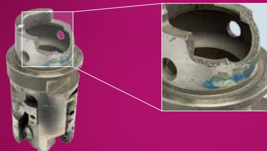
**Sonderwerkzeug mit beschädigter HSK Aufnahme**
