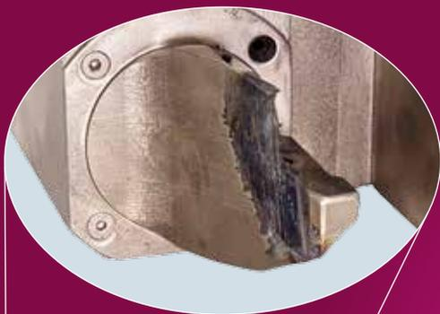
Grundkörper durch Kollisionen beschädigt
