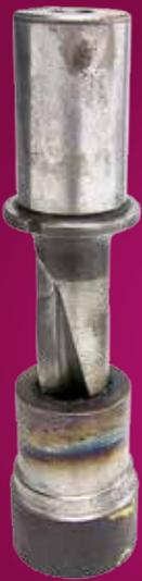
Wendepplattenbohrer unterliegen sehr starkem Verschleiß. Versagt die Kühlung, so führt dies automatisch zum Wendepplattenbruch und zur Werkzeugbeschädigung. Die Plattensitze werden beschädigt und der Werkzeugkörper angefressen. In manchen Fällen steckt der Bohrer sogar in dem zu bearbeitenden Teil fest.
