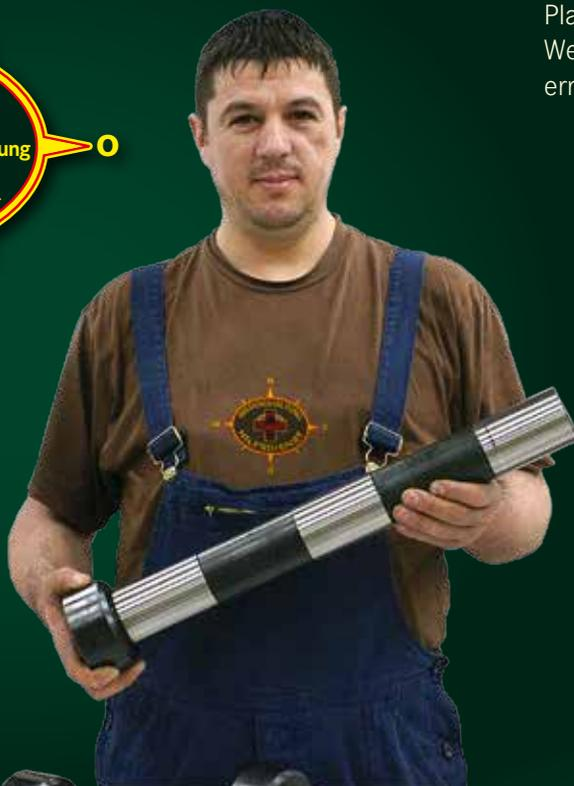
Wellen gerade gerichtet und anschließend Plan- und Rundlauf korrigiert, sodass die Wellen wieder die geforderten Toleranzen erreichen und einsatzbereit sind.
