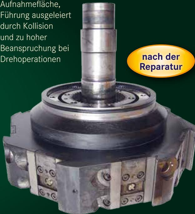
Werkzeugrevolver können nach mehrmaligen Kollisionen oder zu hoher Beanspruchung beim Drehen an den Werkzeugaufnahme­flächen Stauchungen, Risse, Unebenheiten oder Deformationen der Spann­flächen­geometrie aufweisen. Mit der Zeit können auch die Auflagesitze ausleieren. Dadurch ist kein hochgenauer, funktionsfähiger Dreheinsatz mehr möglich.
