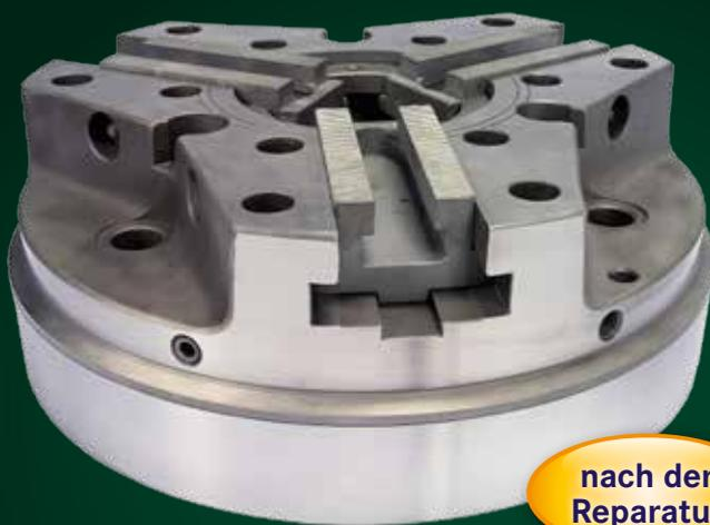
Beschädigungen durch Kollision und ausgeleierte Klemmführungen, die den Präzisionsanforderungen nicht mehr entsprechen, können nachgearbeitet werden (Hartauftragung für Verschleißschutz, anschließend neu eingeschliffene Führungen), sodass kein Kippen und kein Spiel beim Klemmen der Teile mehr vorhanden ist.
