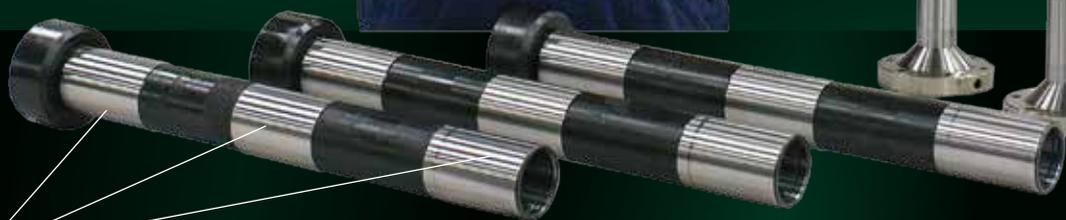
Reparierte und neu geschliffene Lagersitze in h6-Ausführung – passgenau für neue Lager
