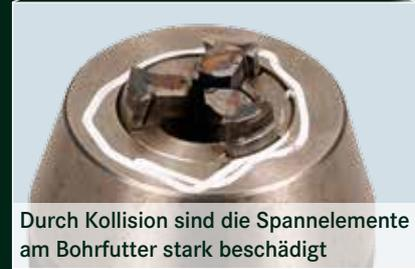
Durch Kollision sind die Spannelemente am Bohrfutter stark beschädigt
