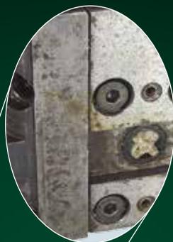
Beschädigte Aufnahme­fläche, Führung ausgeleiert durch Kollision und zu hoher Beanspruchung bei Drehoperationen
